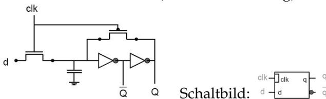
**Master/Slave Latch** Gefahr, dass d sich in der 1 Phase von clk ändern kann (d transparent mit q verbunden)
